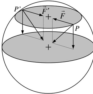
**Figure 3** Toute composante  $\vec{F}$  parallèle au plan de séparation des hémisphères, est compensée par une autre composante  $\vec{F}'$  diamétralement opposée.
