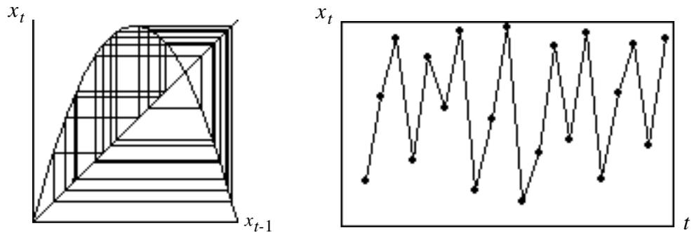
Fig. 3: L'itération graphique de la parabole se fait ici à partir de la valeur initiale  $x_0=0.2$ . On place ce point sur la droite  $y=x$ , on s'élève jusqu'à la parabole pour obtenir  $y=f(x)$ , puis on trace une horizontale jusqu'à la droite. On trouve ainsi  $x_1$ . En répétant ce procédé, on obtient les points de la série temporelle.
