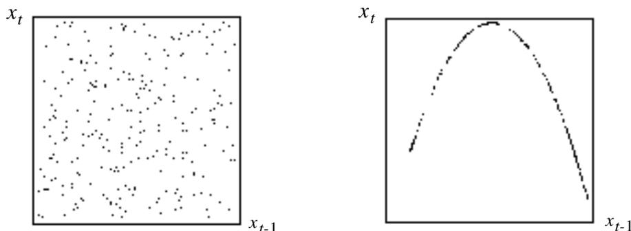
Fig. 2: En reportant  $x_t$  en fonction de  $x_{t-1}$ , on voit apparaître des points distribués uniformément si la série temporelle est aléatoire, et une structure si la série est déterminée.
