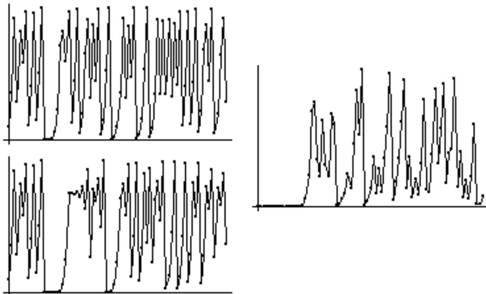
Fig.1: Séries temporelles obtenues à l'aide d'un modèle chaotique. A gauche, comparaison de deux évolutions obtenues à partir du même modèle, mais pour une valeur initiale différant d'un millionième. A droite, évolution de la valeur absolue de la différence entre les deux séries temporelles. L'amplitude des erreurs est du même ordre de grandeur que l'amplitude des séries elles-mêmes. Ce comportement est typique des systèmes chaotiques.
