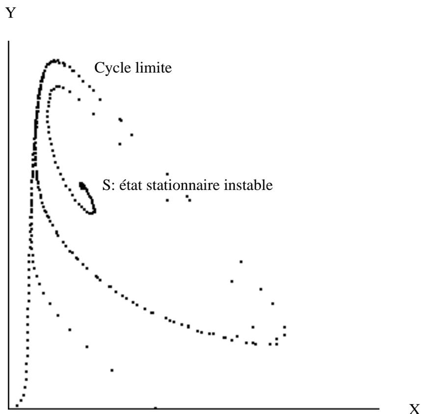
Fig. Si on perturbe un peu l'état stationnaire S, le système décrit alors dans l'espace X, Y, une trajectoire périodique. Le système tend vers la même trajectoire quelle que soit la position initiale  $(X_0; Y_0)$ : nous avons affaire à un cycle limite.
