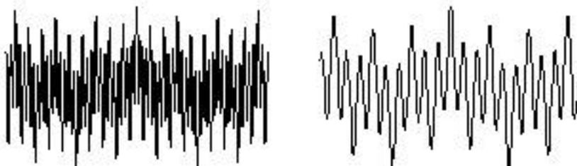
Fig. 1: La courbe de gauche correspond à une approximation d'une fonction de Weierstrass. La courbe de droite est obtenue en agrandissant une partie de la courbe de gauche. Malgré l'approximation utilisée, on constate que la fonction obtenue possède déjà une certaine autosimilitude: lorsqu'on agrandit une de ces parties, on retrouve une courbe qui présente la même allure.
