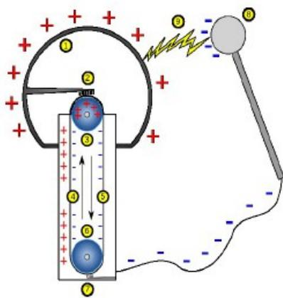
De l'autre côté, la courroie achemine des charges négatives sur une électrode inférieure destinée à les collecter. Ainsi lorsqu'on approche un objet chargé négativement de la sphère les électrons vont vouloir passer sur la sphère dû à la grande différence de potentiel. Mais l'air qui est un isolant empêche ce passage jusqu'au moment où la différence de potentielle devient si grande que les charges créent un canal dans l'air, chauffe l'air et crée une étincelle.
