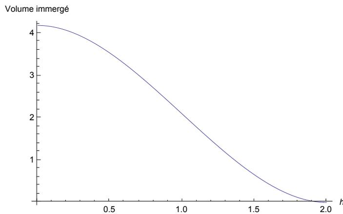
Si la sphère flotte, son poids est égal à la poussée d'Archimède. Exprimons le rapport  $q$  de la masse volumique de la sphère  $\rho_1$  à celle du liquide  $\rho_2$  en fonction de la hauteur émergée  $h$  :
